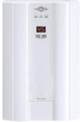
Elektronisch gesteuerter Durchlauferhitzer mit Blankdraht-Heizsystem im Kompaktformat zur Warmwasserversorgung von einer oder zwei Zapfstellen im Temperaturbereich von 35 °C bis 55 °C. Über zwei Folientasten kann die gewünschte Auslauftemperatur gewählt werden. Die Leistungselektronik regelt die Heizleistung, um die Auslauftemperatur grad-genau zu erreichen und konstant zu halten. Das Gerät ist für Aufputz- und Unterputzrohrinstallation geeignet.
