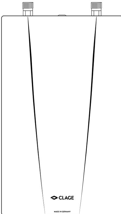
Le chauffe-eau instantané CDX 7-U / CDX 11-U est un appareil résistant à la pression commandé par microprocesseur destiné à la fourniture décentralisée d'eau chaude en un ou plusieurs points de prélèvement.
